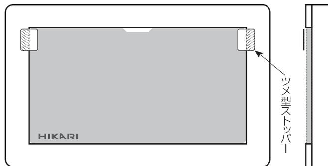
⑤取り外す場合は、フィルター中央の型抜き部に指をひっかけゆっくりと引っ張り、山折に折り曲げ、左右のハメコミ口を外して下さい。ツメ型ストッパーを使用している時は、ツメ型ストッパーをはずしてください。次に、下部のハメコミ口を外してください。
