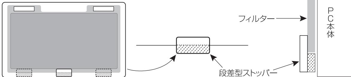
④の取り付け作業終了後、下記の「取付方法② 段差型ストッパー取付」を参考に段差型ストッパーを画面下部中央に1個貼付して、フィルターを固定してください。安定した取り付けになります。
