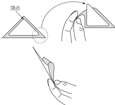
3. トライアングルテープの頂点を、フィルター裏面の角に合わせて貼り付けて下さい。角に指を置いて上方向に指で押さえて密着させて下さい。セパレーターをめくりながら、斜め下方向に指で押さえて密着させて下さい。
