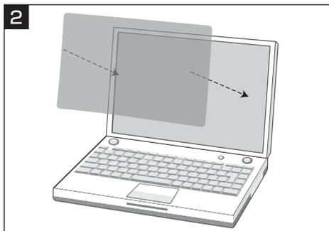
2. 保護フィルムをはがしたフィルターの表裏面を確認し表面を上にしてモニター上に置いてください。
