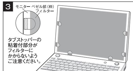
3. タブストッパーでフィルターを押しやるようにしながらモニターのベゼル部分に粘着付部分をお貼りください。フィルターに粘着付部分が着かないようご注意ください。
