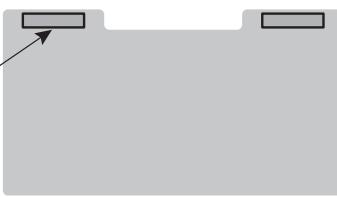
アイアンストッパーのリケイフィルムをめぐりフィルター裏面に上図のように貼り付けしてください。
