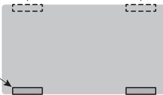
PC画面にアイアンストッパーをあてて、マグネット内蔵部の位置をご確認ください。アイアンストッパーのリケイフィルムをめぐりフィルター裏面の下辺に沿うように、貼り付けしてください。IRO-110、IRO-129はアイアンストッパーの取付位置が上部になります。
