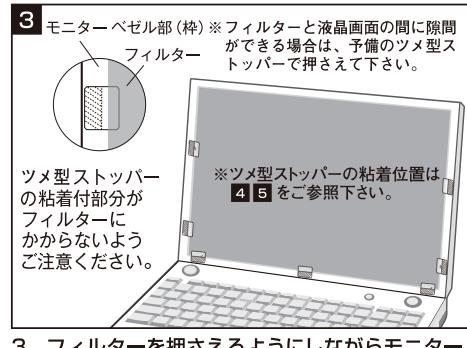
3. フィルターを押さえるようにしながらモニターのベゼル部分にツメ型ストッパーの粘着付部分をお貼りください。フィルターに粘着付部分が着かないようご注意ください。
