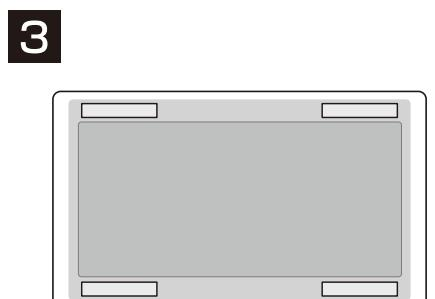
再剥離粘着テープを台紙からはずして、フィルター裏面に図のように4カ所貼付してください。この時リケイフィルムがはがれないようにご注意ください。
