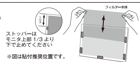
3. フィルターを押さえるようにしながらモニターのベゼル部分に段差型ストッパーの粘着付部分をお貼りください。フィルターに粘着付部分が着かないようご注意ください。
